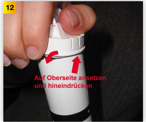
12 Aufklicken (Aufdrücken) der Ventileinheit auf den Zylinder.
