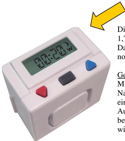
Die Elektronik ist grundsätzlich im Standby-Modus und braucht dabei nicht mehr als 1,7uA Strom. Daher ist auch das LCD-Display ausgeschaltet. Das sorgt dafür, dass in der Regel über 10 Jahre kein Batteriewechsel notwendig ist. Die handelsübliche Lithium-Batterie ist vom Type CR 2450.
